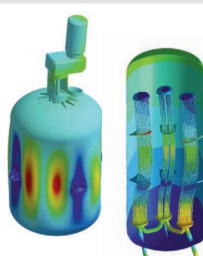
**B** модальный анализ для определения собственных частот
